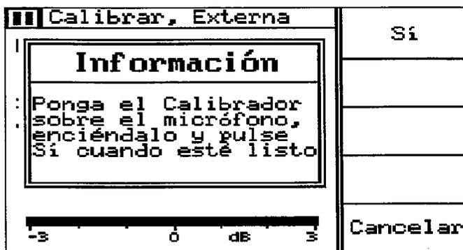
Fig. 4.3 Menú «Calibración externa» indicando el modo en el que ha de proseguir.
