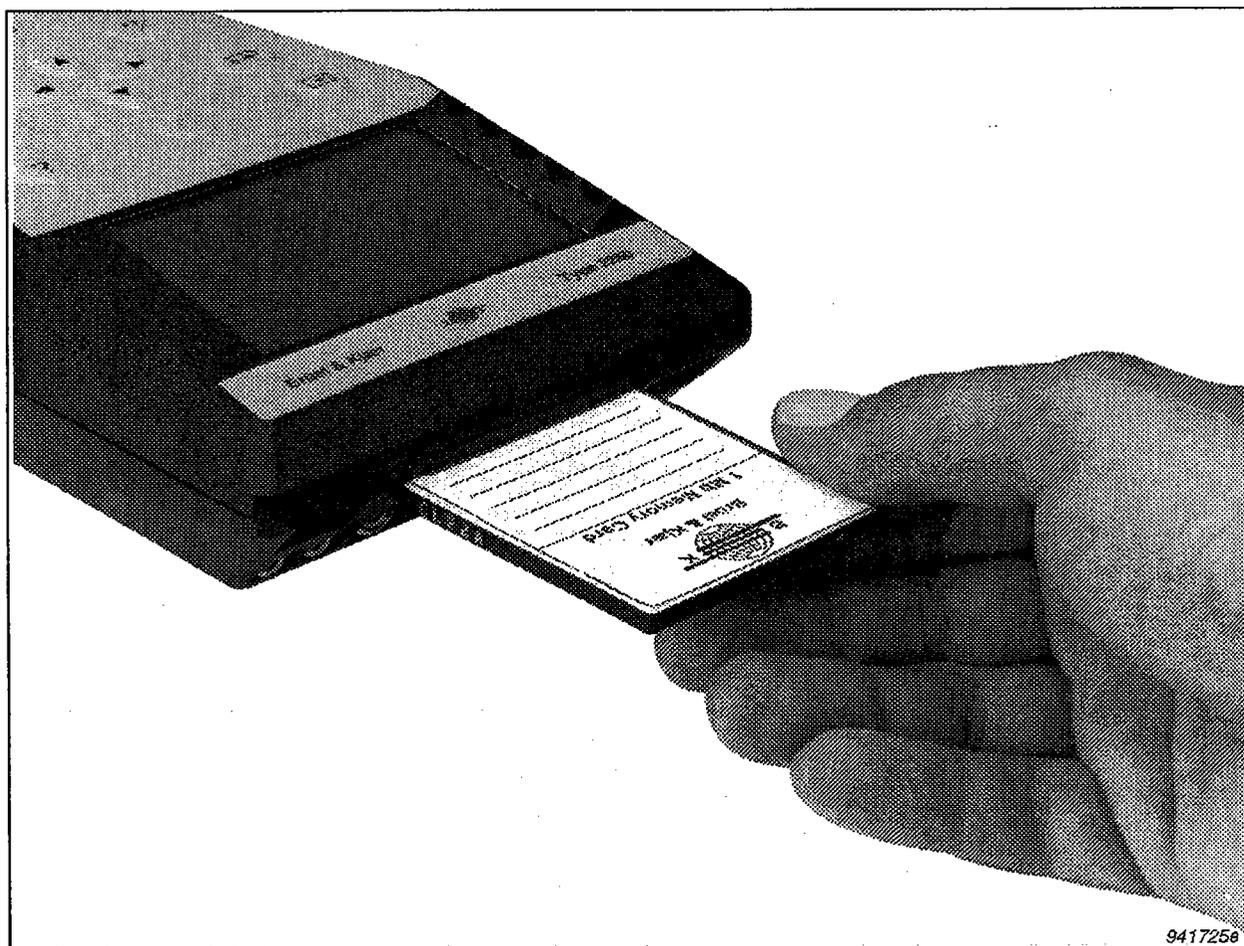
*Fig. 4.5 Insertando una tarjeta de memoria en la ranura PCMCIA de la base del analizador*
